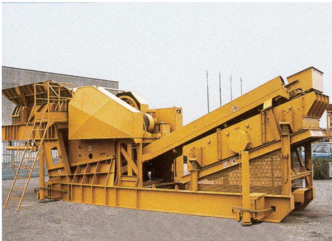
Fig.1 – Impianto di frantumazione primaria e vagliatura (0-100 T/h)
